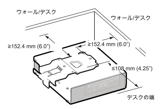
**る** ブラケットが水平で高さも均一、さらに表面にぴったり付着するように注意 しながら、デスク下に取り付けます。
