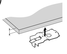
注意:取り付けネジはブラケットには添付されていません。適切なネジを使用し23kgを支えられる取り付け面に取り付けを行なってください。 取り付け面は最低でも12.5cmの厚みの木材でM4、12mmの木ネジを使用することが必要です。
