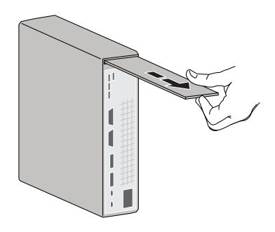
3 下図に示すように、取り付け方法に適した方向で、システムスリーブにシステムを挿入します。
