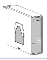
4 システムラベル キャリアをシステムスリーブに押し入れ、次にスイッチをスライドさせてロックします。
